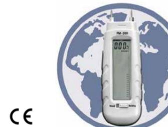
**EQ0375** Permet de déterminer l'humidité du bois et des matériaux de construction. Évalue la proportion d'eau de l'échantillon par rapport à la masse sèche. Utilise des valeurs de références moyennes. Affiche en bargraphe et en direct la valeur en % de façon numérique. Pointes de mesure en acier interchangeables et possède un capuchon protecteur.
