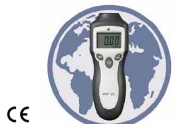
**EQ0569** Cet appareil mesure les micro-ondes émises par les appareils à haute fréquence. Mesure de 0 à 9,99 mW/cm². Possède une précision de +/- 1 db. Résolution de l'affichage de 0,01 mW/cm². Bande passante de 2 450 MHz. Ce radiomètre mesure rapidement et simplement le rayonnement. Possède un écran rétroéclairé pour un meilleur affichage et une meilleure lecture.
