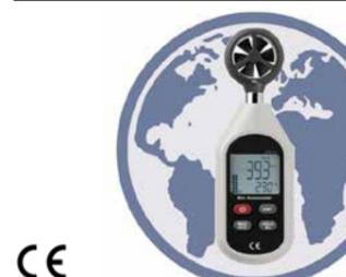
**EQ0563** Cet anémomètre permet de mesurer la vitesse du vent et l'écoulement des gaz. Mesure de 0,3 m/sec à 30 m/sec avec une précision de 5 %. Forme compacte et maniable. Détermine la vitesse moyenne ou la vitesse maximale de chaque mesure et les affichent sur l'écran. Affiche 5 unités différentes : m/s ; ft/min ; km/h ; mile/h ; nœud.
