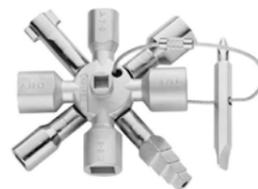
**EQ0770** La clé 10 empreintes est idéale pour les coffrets eau, gaz et électricité. Elle est à utiliser pour les ouvertures et fermetures des coffrets, chauffage, sanitaire, climatisation, ventilation, gaz et eau. Possède un système d'arrêt. Embouts : Clé carré femelle : 5 ; 6-7 mm ; 8-9 mm ; 10-11 mm. Clé triangulaire : 7-8 mm ; 9-10 mm ; 11-12 mm. Panneton double : 3-5 mm. Fente demi-lune : 6 mm. 4 pans : 6-9 mm.
