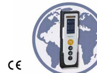
**EQ0756** Télémètre d'intérieur avec rayon laser pour mesurer des longueurs jusqu'à 20 mètres. Fonction surface et volume pour les dimensions d'une pièce. 3 plans de mesure commutables. Fonction min/max pour l'évaluation de distances diagonales, horizontales et verticales avec affichage de la valeur de différence. Broche pour les mesures à partir d'angles.
