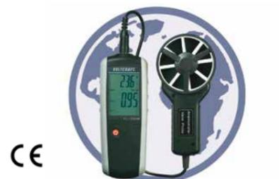
**EQ0564** Anémomètre avec turbine à faibles pertes. Indication de la vitesse de l'air en m/min, le débit volumique en m³/s et la température de l'air, sur un écran rétroéclairé. Résolution du débit volumique de 0,001 à 100 m³/min. Plage de mesure débit volumique : 0 - 999900 m³/min. Plage de mesure de la température : -10 à +60 °C. Résolution température : 0,1 °C. Fonction Hold [m³/min ou m/s]. Valeurs maximales, minimales et moyennes
