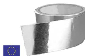
**EQ0843** Ruban adhésif en aluminium pour faciliter l'installation des réflecteurs pour radiateur et toutes les solutions d'isolation. Épaisseur 30 microns. Résistant aux fortes températures (-30 à +120°C), aux UV et à l'humidité pour un usage intérieur et extérieur. Qualité professionnelle / Excellente résistance à l'usure. Rouleau de 50 Mètres de long avec une bande adhésive de 5 cm adapté au jointage.
