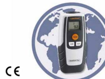
**EQ0757** Ce télémètre à ultrason a une portée de 13 mètres avec visée laser pour faciliter la mesure. Idéal pour les mesures en intérieur dans des pièces vides. Mesure des surfaces et des volumes. Fonction addition de longueurs et 2 plans de mesure commutable : arrière et avant.
