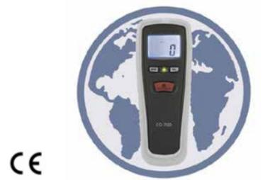
**EQ0813** Cet appareil permet de contrôler la teneur en monoxyde de carbone dans l'environnement. Plage de mesure allant de 0 à 1 000 ppm, avec une précision de +/- 5 % et 10 ppm. La teneur en monoxyde de carbone est affichée sur l'écran LCD et une alerte sonore retentit en même temps.
