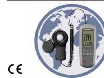
**EQ0816** Mesure la force d'éclairage et la luminosité d'une lampe à incandescence classique et LED. Mesure l'intensité de l'éclairage en lux ou foot candle et l'intensité lumineuse en candelas. Mesure de 0,1 à 400 000 lx avec une précision de +/- 3 %. Affichage numérique LCD. Possède 9 sources lumineuses et facteurs de correction préprogrammés.
