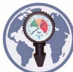
**EQ0606** Mesure entre 0 et 10 bars/ température maxi 60°C. Sans joint, sans clé, sans vissage, juste par emboîtement du cône de mesure. Permet le contrôle rapide de la pression sur n'importe quel orifice dont le diamètre est compris entre 8 et 20 mm / IP 65 / classe 2.5 / Ø 50 mm. Marquage couleur des plages de pression.
